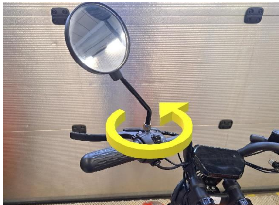
Löysää vasemman peilin lukitusmutteri (kiintoavain 14 mm) ja pyöritä peili irti.
