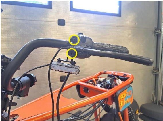
Löysää vasemman kahvarungon kiinnitysruuvit (ristipäämeisseli ph2).
