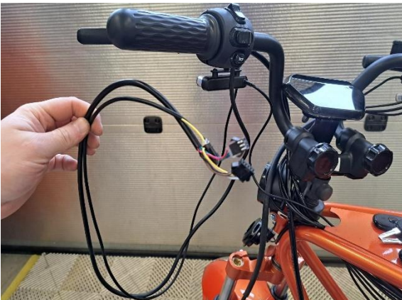
Vedä vasemman kahvarungon johdot irralleen johtosarjasta.
