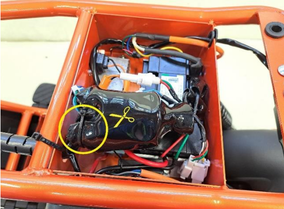
Katkaise johtojen suojaa kiinni pitävä nippuside (sivuleikkurit).
