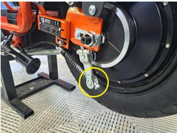
Löysää takajarruvaijerin kireyden säätö mutteri löysimmilleen. (kiintoavain 14 mm).
